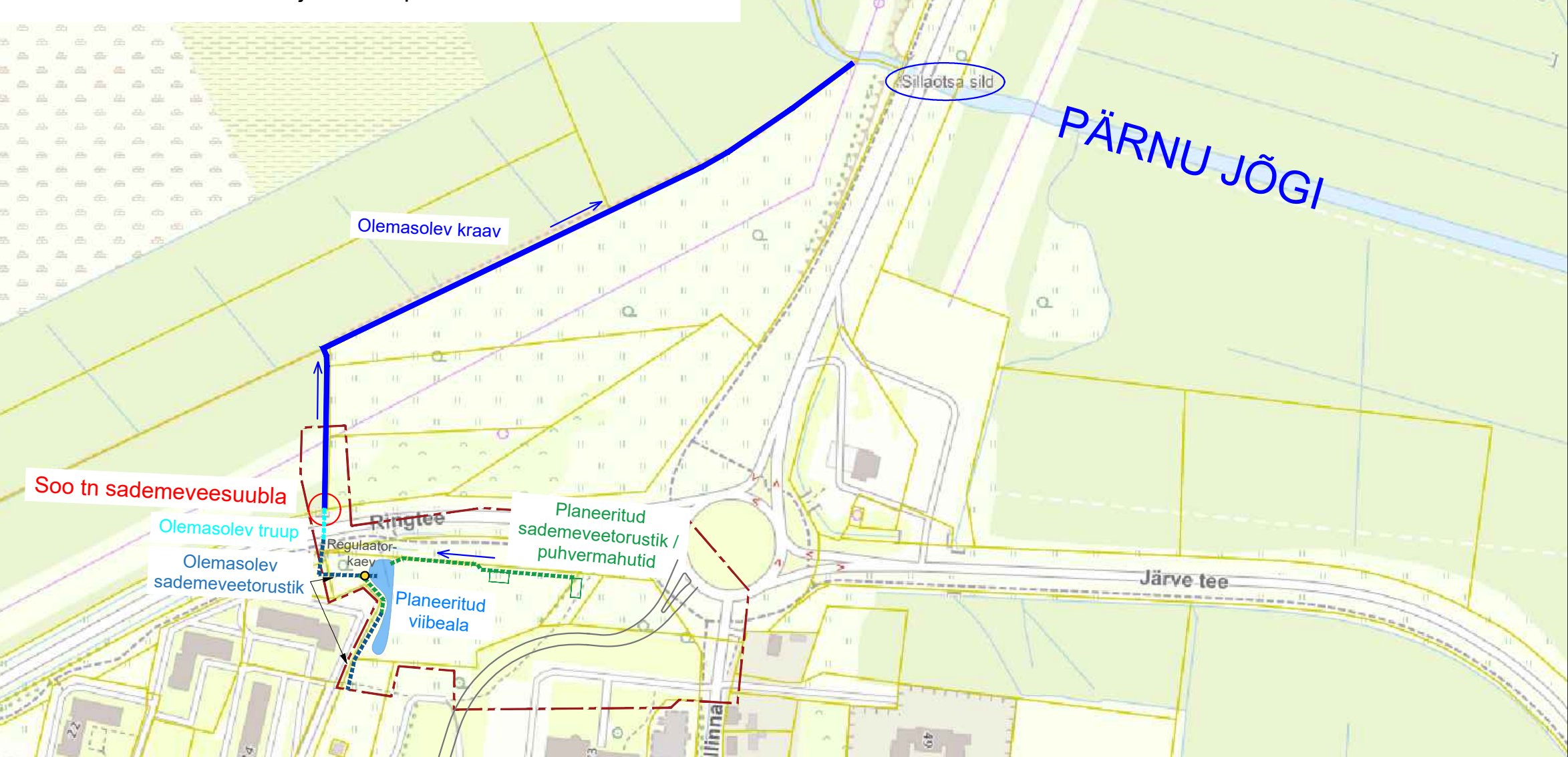
SKEEM 1. Sademevee ärajuhtimise põhimõtteline lahenduskeem
